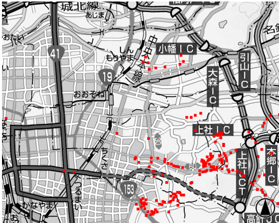
図 4 AM8 時～AM9 時における 50 台分のタクシーデータを用いた渋滞地点の視覚化
