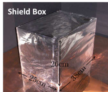
図10 シールドボックスで遮へいしたときの実験のモデル
